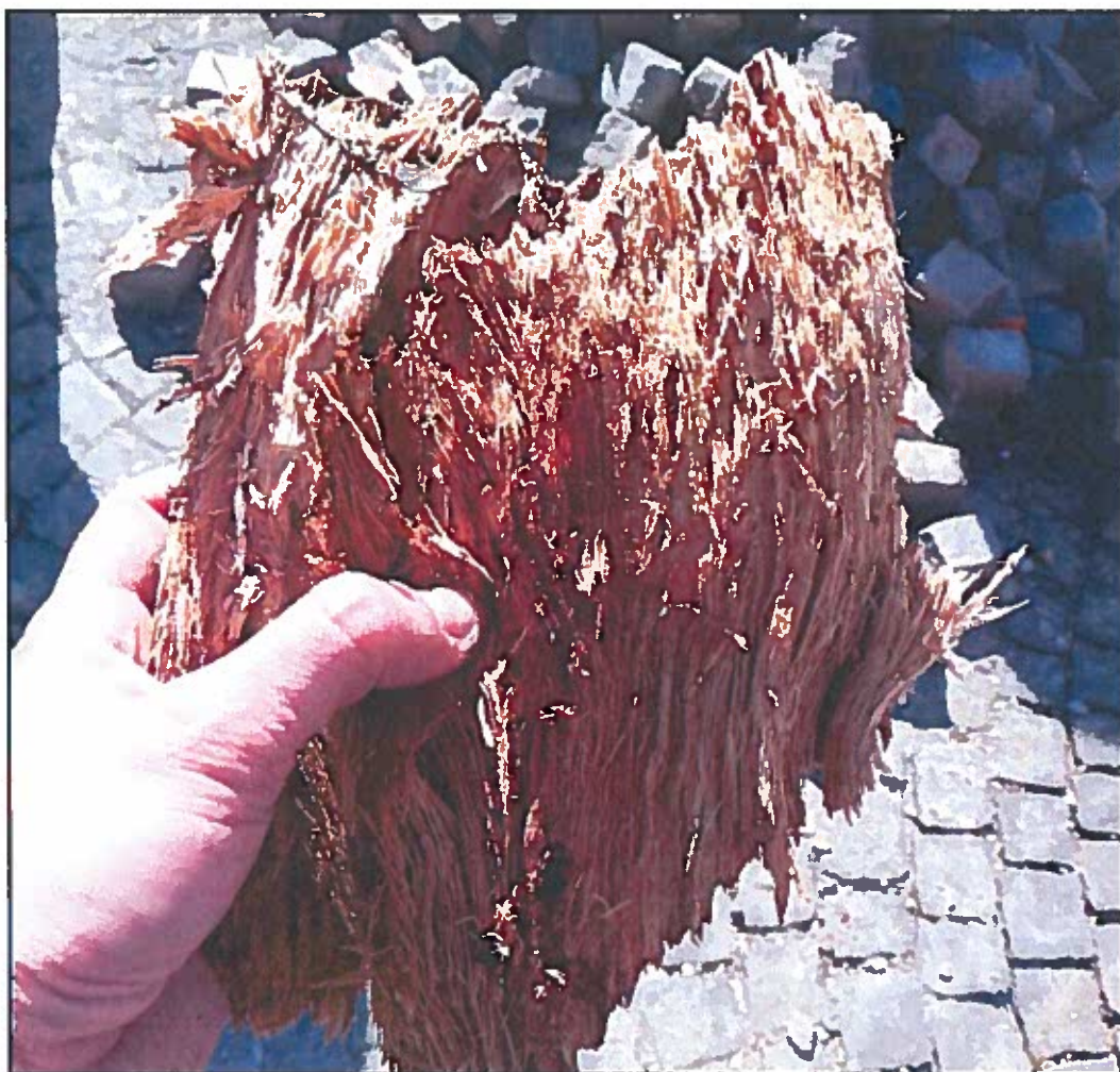
Foto 5: legno degradato e inconsistente estratto a mano dalla cavità alla base.
